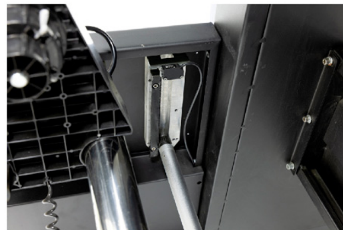
Утяжелитель с датчиком, отслеживающим положение петли
