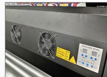
Мощная ИК-сушка с электронной регулировкой мощности излучения
