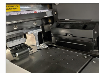
Датчик препятствия для защиты печатающих головок
