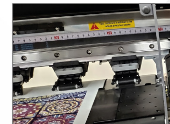
Широкие прорезиненные прижимные ролики
