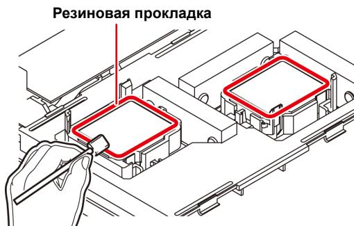
**8**После очистки нажмите клавишу **ENTER**.**9****Закройте переднюю крышку и нажмите клавишу **ENTER**.**
