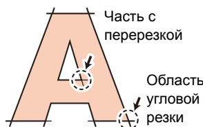
OVER CUT (Перерезка): OFF (Выкл.)
