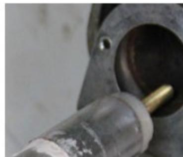
3. Вставить нагревательную трубку внутрь верхнего вала
