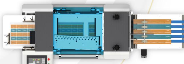
Ротационная высекальная машина серии MCT-5035, представляющая собой интеллектуальную систему резки для мелкосерийного и многотиражного производства, предназначена для изготовления всевозможных наклеек, этикеток, карточек, бирок для одежды, ярлыков, игральных карт и другой продукции, используемой в полиграфической, упаковочной, швейной и электронной промышленности.
