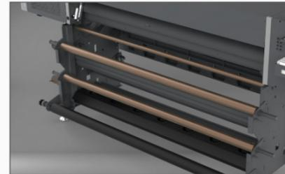
Система размотки/подмотки материала
