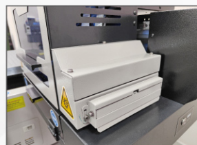
Устройство защиты каретки от повреждения
