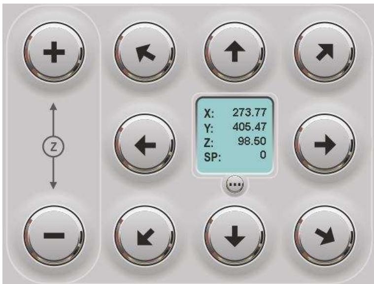
Направление перемещения – прямое, то есть, в какую сторону указывает стрелка, в ту же сторону происходит перемещение шпинделя. В среднем секторе отображаются текущие координаты шпинделя. При нажатии на этот сектор появляется всплывающее окно «Переместиться в», в котором можно указать координаты для заданного перемещения шпинделя.
