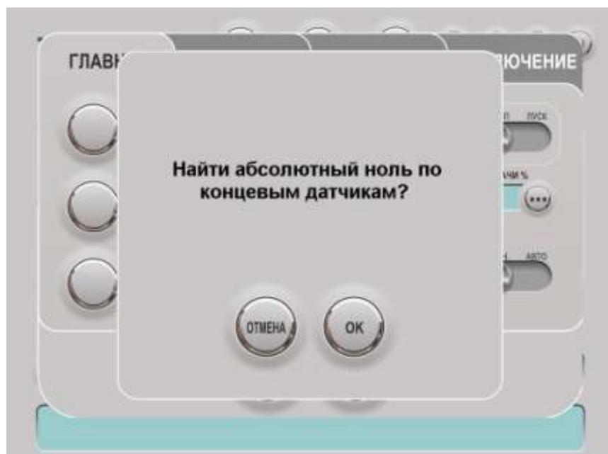
Выберите «ОК» для начала поиска, или «ОТМЕНА» для отмены поиска абсолютного нуля. При отмене поиска станок будет находиться в относительной системе координат, что может привести к сбоям в работе. Более подробно об абсолютном нуле читайте далее.
