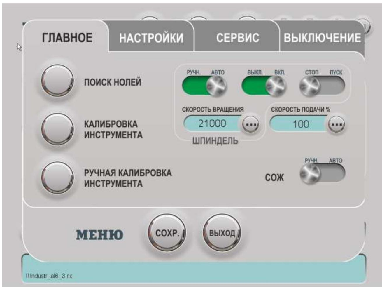
1.2. Клавиша КАЛИБРОВКА ИНТРУМЕНТА – автоматическая калибровка длины инструмента по встроенному в стол датчику поверхности. Сохраняется после выключения включения станка. Обязательно проводится при смене любого инструмента в шпинделе. Невыполнение калибровки высоты установленного инструмента может привести к «недорезанию» задания или «перерезанию» его, поломке фрезы и повреждению жертвенного слоя или вакуумных профилей стола.
