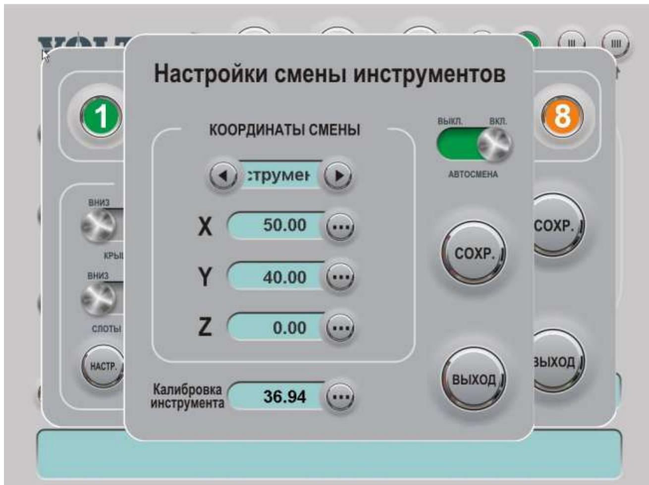
«Калибровка инструмента» отображает откалиброванную длину каждого из инструментов. Это значение можно корректировать при необходимости. При ручной корректировке длины инструмента следует соблюдать осторожность, т.к. неправильно введенная калибровка может привести к поломке фрезы или порче жертвенного или вакуумного стола, других частей станка.
