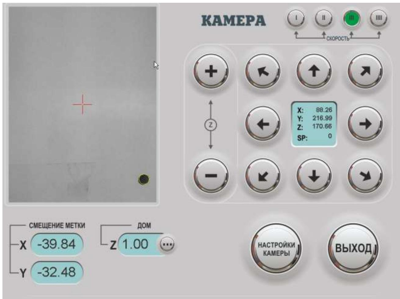
Для настройки камеры на резкость, под камеру на стол кладется лист бумаги с нарисованными шариковой ручкой двумя линиями. Расстояние между линиями 3-5 мм. Вращая настройку фокуса на объективе камеры нужно добиться максимально четкого изображения линий на экране.
