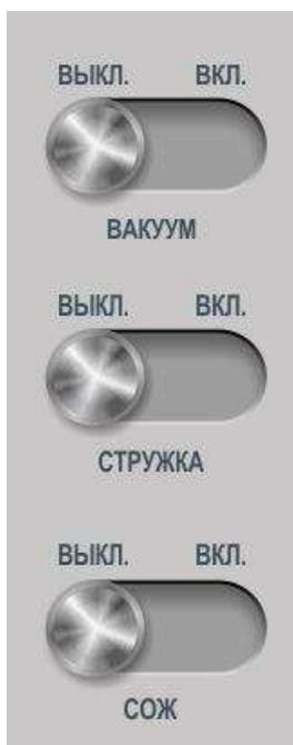
ВАКУУМ - ручное включение/выключение вакуумного насоса (если имеется в комплектации). Клавиша серая – устройство выключено, зеленая – включено.
