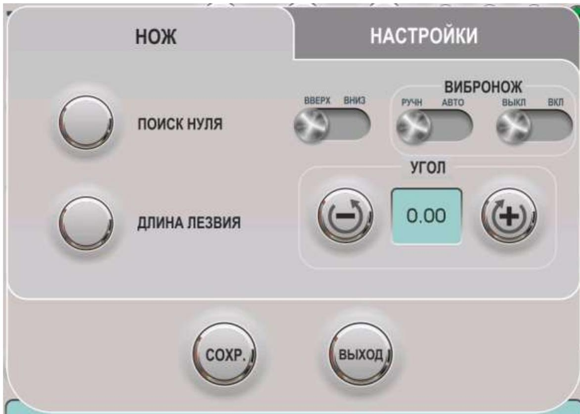
ПОИСК НУЛЯ – поиск нулевого положения ножа, выполняется по датчику. Необходимо выполнять каждый раз при включении станка или после каждой смены лезвия.
