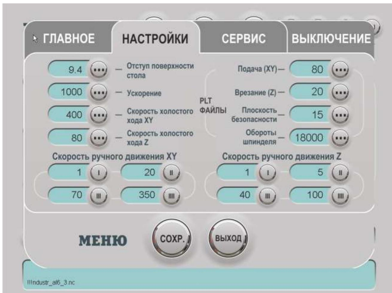
2.1. В верхней части подменю расположены установки: «Скорость холостого хода XY» – скорость в мм./сек. Холостого перемещения между фигурами по осям X и Y, «Скорость холостого хода Z» – скорость в мм./сек. Холостого перемещения по оси Z,
