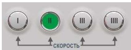
Клавиши I, II, III, IIII переключают между четырьмя основными скоростями холостого перемещения станка. Активная клавиша скорости выделяется зеленым. По умолчанию значения скоростей по осям X и Y: I – 1 мм/сек, II – 25 мм/сек, III – 200 мм/сек, IIII – 400мм/сек,
